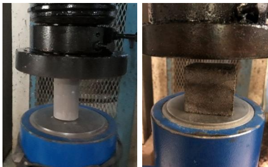
Gambar 2. Pengujian Tekan Pasta dan Mortar Geopolimer
