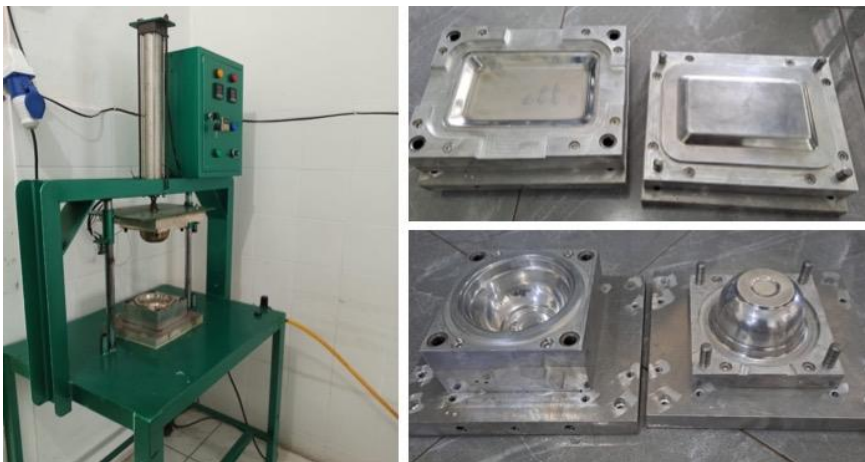
Gambar 2. Mesin thermopressing beserta bagian molding
