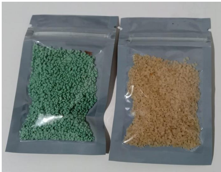
Gambar 3. Foto produk pupuk slow release Cu dan Zn berbasis alginat/kaolin hasil produksi
