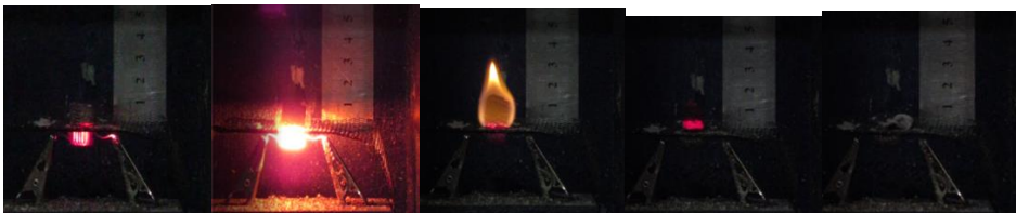
Gambar 4. Pengujian Karakteristik Pembakaran Pellet Kayu Gelam
