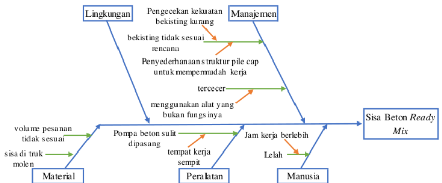
Gambar 4. Fishbone Diagram untuk Penyebab Waste Beton Ready mix
