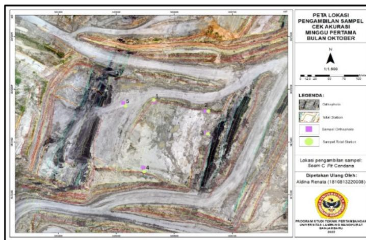
Gambar-4. Akurasi orthophoto dan total station minggu ke-1 Oktober
