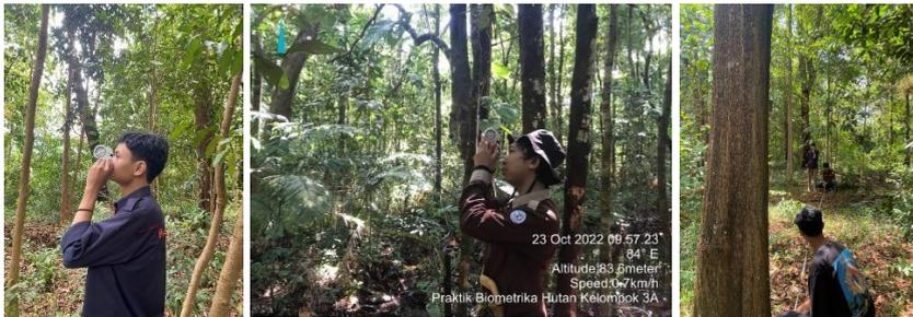
Gambar 4.13. Cara Penggunaan alat Suunto Clinometer dengan jarak 15 meter di lapangan
