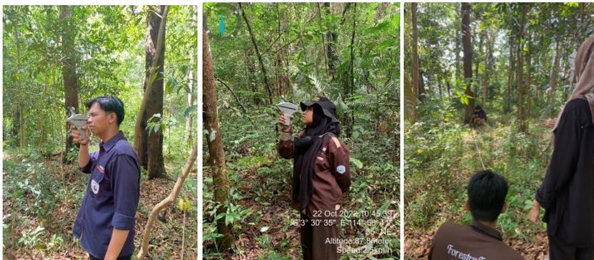
Gambar 4.17. Cara Penggunaan alat Hagameter dengan jarak 15 meter di lapangan
