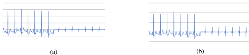
Gambar 4. Visualisasi Data EKG (a) Hasil Transformasi Level 1 dan (b) Hasil Transformasi Level 2
