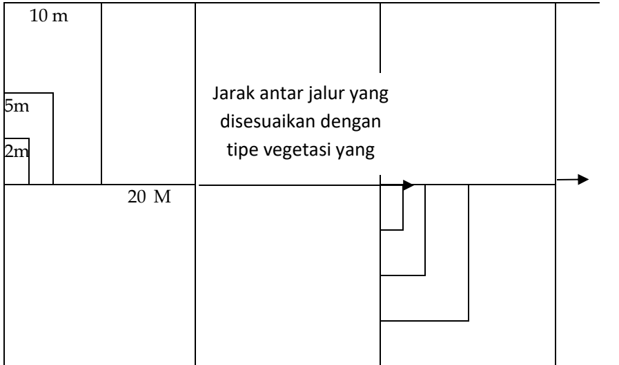
Gambar 2.1. Skema penempatan transek dan petak-petak pengukuran pada analisis vegetasi dengan metode jalur berpetak.
