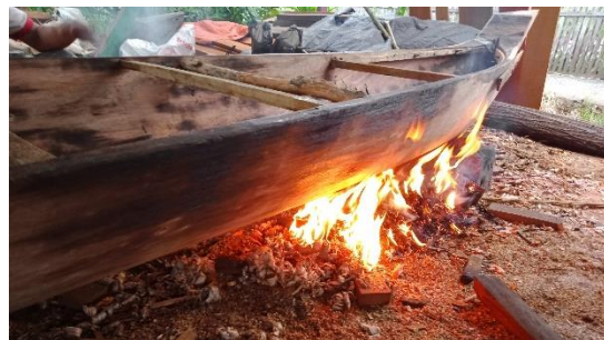
Gambar 2. Kerongkong yang dibeli dari Manusup kemudian dipanggang oleh pengrajin untuk mendapatkan badan jukung menjadi lebar. Proses ini merupakan tahapan awal dalam pembuatan Jukung Sewangi. Sumber: Peneliti 2022
