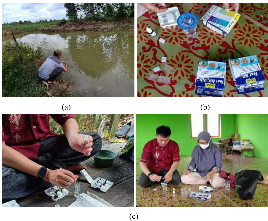
Gambar 4. Pengukuran kualitas air kolam budidaya ikan haruan (a) pengambilan sampel air (b) bahan dan indikator pengujian kualitas air (c) pengujian sampel air
