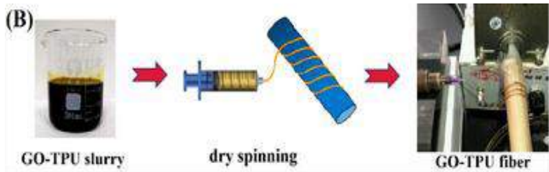
Gambar 5.9 Diagram Skema Proses Pemintalan Kering (Feng et al., 2021)
