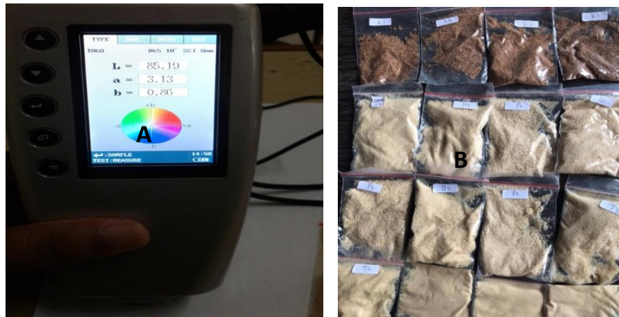
Keterangan: A, Alat yang digunakan untuk uji colour change; B, Sampel Uji
