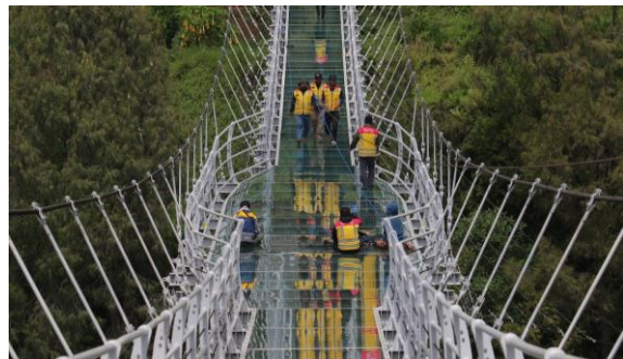
Gambar 8. Uji getar Jembatan Kaca Bromo dengan trigger orang berjalan kaki
