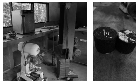
Gambar 2. (Kiri) Peralatan untuk Produksi Sampel dan (Kanan) Sampel Briket Aspal hasil produksi
