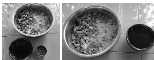
Gambar 1. (Kiri) Campuran aspal menggunakan polimer EVA dan (Kanan) Campuran aspal menggunakan PMB PG-76
