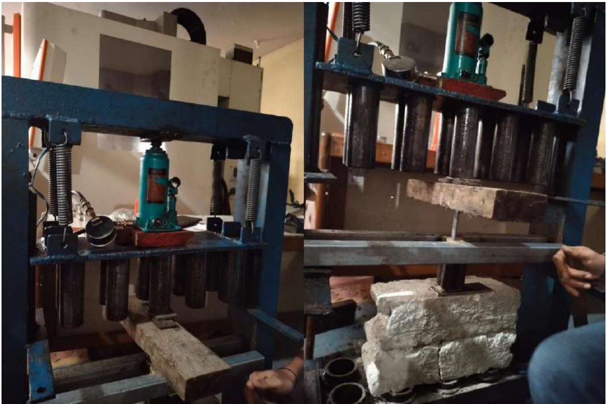
Lampiran 1. Proses pembuatan pellet (a). Gambar alat pencetak pellet dan (b). Proses pencetakan pellet
