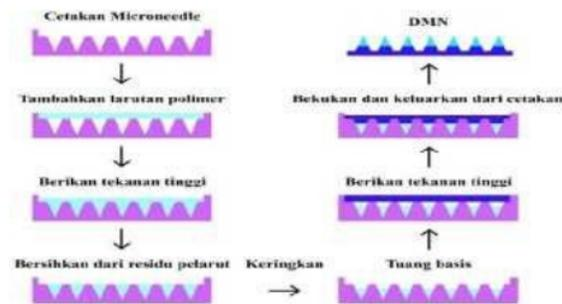
Gambar 6. Tahapan Pembuatan *Microneedle Patch*<sup>14</sup>
