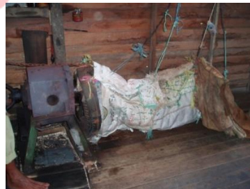
Biji siap mengembang, katup ruang tempat biji dibuka, biji yang mengembang ditampung dalam belalai
