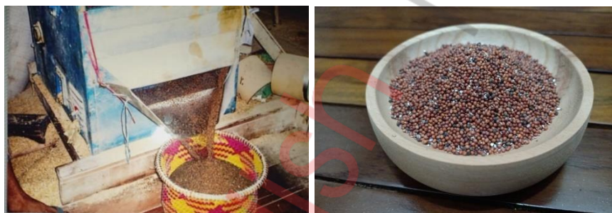
Gambar 3.2. Penyosohan kulit luar biji teratai dengan huller (a) dan biji kupas kulit (b)
