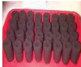
Gb.31 Briket arang yang sudah siap untuk di uji dan dibakar
