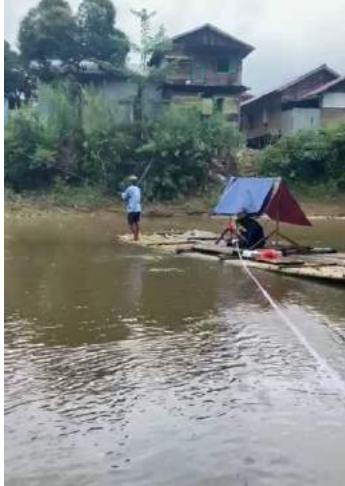
Gambar 3-4 Pengukuran Lebar Sungai dengan Roll Meter
