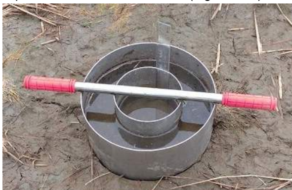
Gambar 3-9 Pengukuran Laju Infiltrasi Tanah
