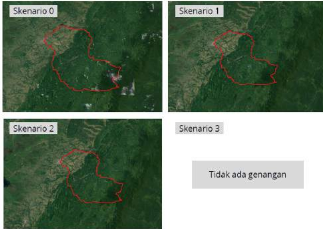
Gambar 7-26 Genangan di DTA Barabai untuk Skenario Hujan 2 Tahunan
