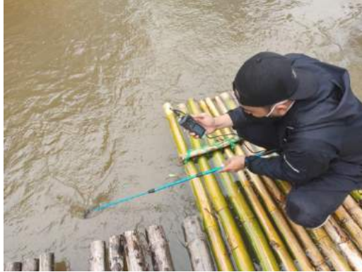
Gambar 3-6 Pengukuran Kecepatan Arus Sungai dengan Current Meter
