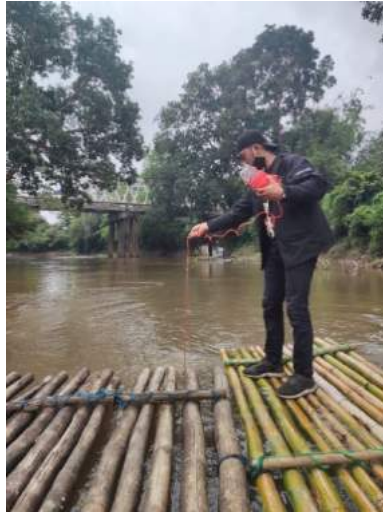
Gambar 3-5 Pengukuran Kedalaman Sungai dengan Tali yang Diikatkan Beban
