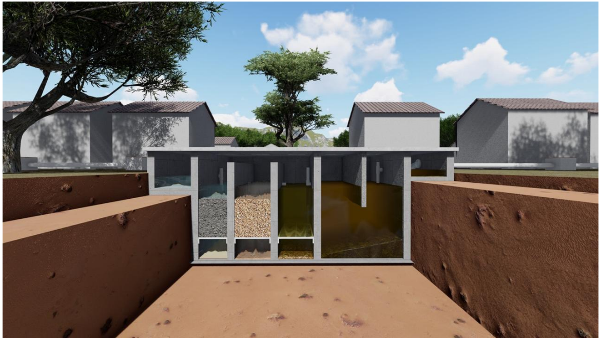
Gambar 4.4 Detail Tanki Septik Komunal yang digunakan untuk pengurai limbah cair dan penjernihan
