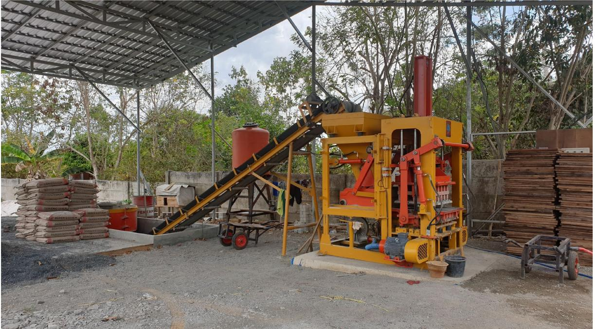
**Gambar IV.5 Alat pencetak *Paving Block* tipe otomatis**
