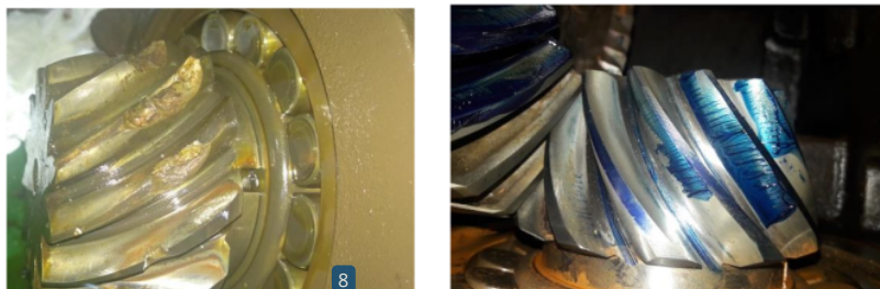
Gambar 13. Pinion Gear sebelum (kiri) dan sesudah (kanan) perbaikan
