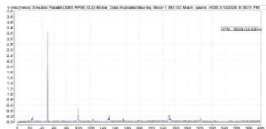
Gambar 12. Spektrum getaran saat kondisi paralel misalignment 0,2 bearing 1
