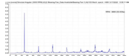
Gambar 39. Spektrum getaran saat kondisi angular misalignment 0,2 bearing 3
