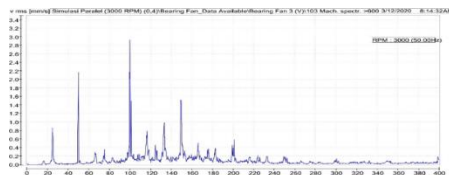
Gambar 24. Spektrum getaran saat kondisi paralel misalignment 0,4 bearing 3
