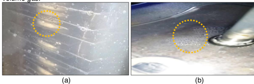
Gambar 10. Gelembung-Gelembung (a). Pada Plat Elektroda (b). Pada Bagian Atas Generator
