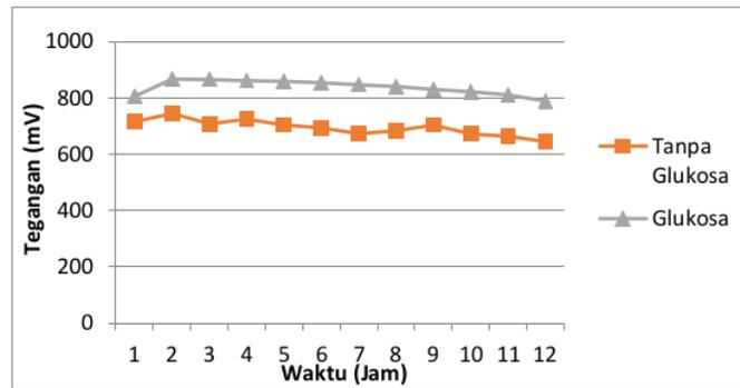
Gambar 6. Perbandingan Tegangan Limbah Pabrik Tahu Tanpa Aerator
