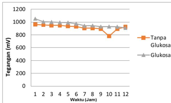
Gambar 9. Perbandingan Tegangan Limbah Perikanan (Kepala Udang dan Kulit Udang) Menggunakan Aerator
