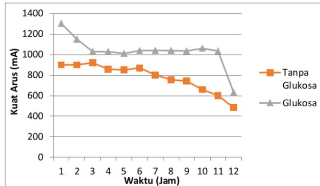
Gambar 4. Perbandingan Kuat Arus Limbah Pabrik Tahu Tanpa Aerator
