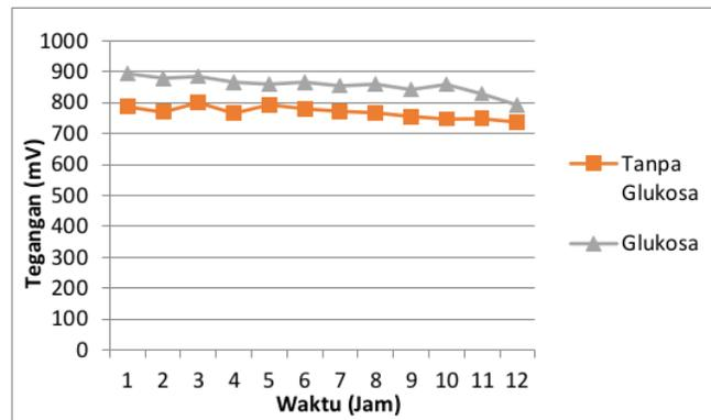
Gambar 5. Perbandingan Tegangan Limbah Pabrik Tahu Menggunakan Aerator
