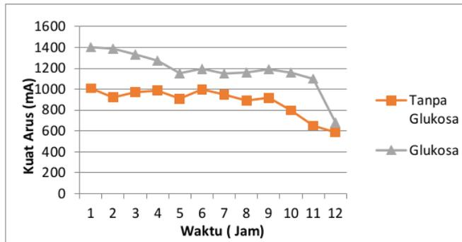
Gambar 3. Perbandingan Kuat Arus Limbah Pabrik Tahu Menggunakan Aerator
