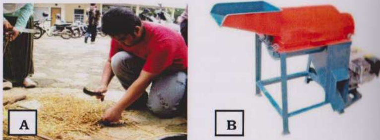
Gambar 2.5. Pencacahan bahan organik seperti jerami dan sampah. A. pencacahan secara manual menggunakan golok ( Banjar : parang) dan B. Mesin pencacah bahan organik
