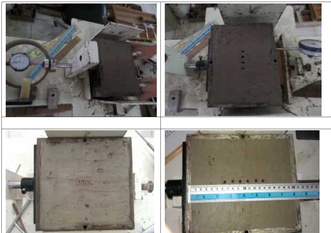
Gambar 4.7 Pengujian geser untuk variasi jumlah cerucuk 2(dua) arah gaya geser
