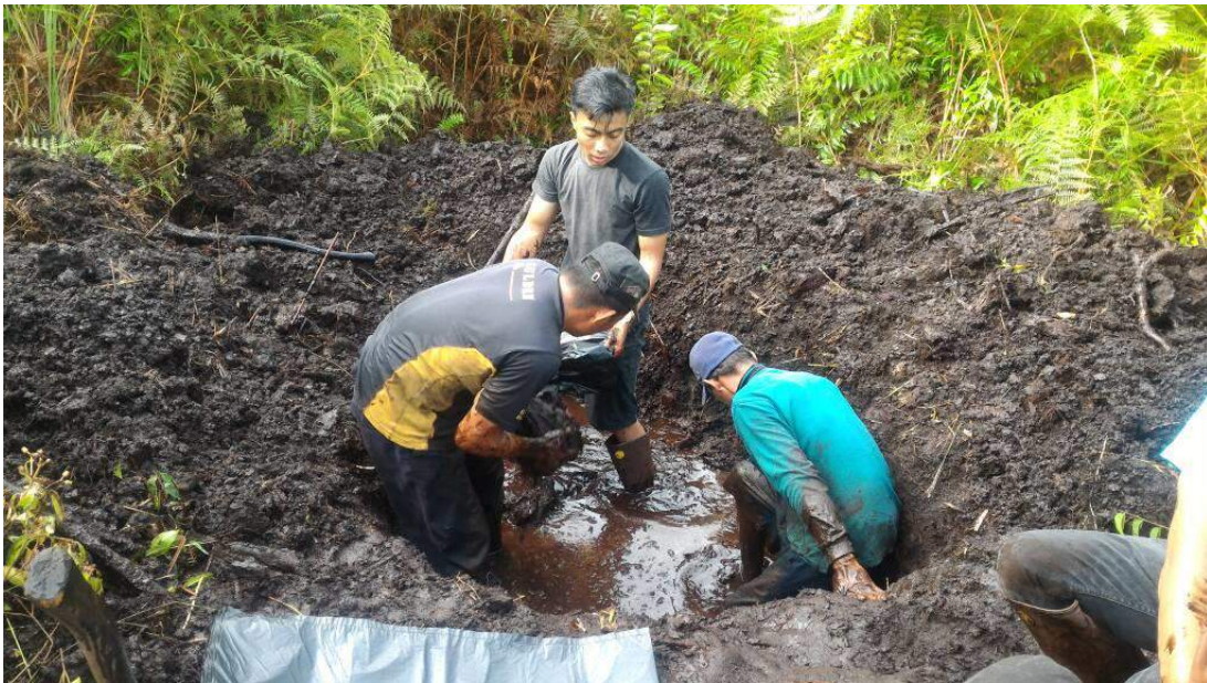
Gambar Lampiran 1.2. Pengambilan sampel tidak terganggu dengan pipa PVC.
