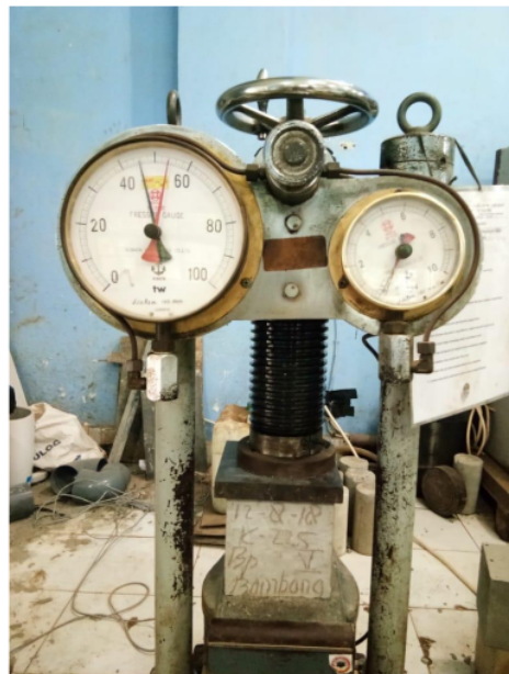
Gambar 4. Benda uji kubus setelah uji kuat tekan beton
