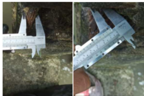
Gambar 5 Dokumentasi Pengambilan Pengukuran Perubahan Diameter Tulangan Beton
