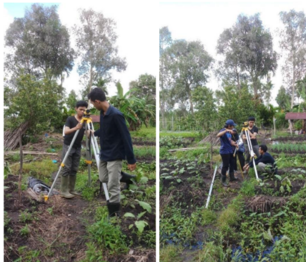
Gambar 4. Pengukuran levelling dengan waterpass
