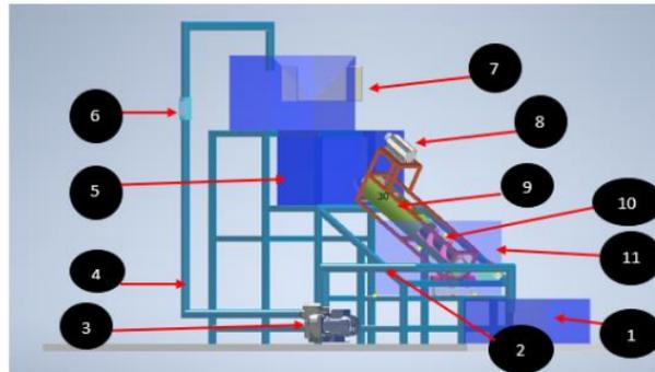
**Gambar 3:** Rancangan PLTPH dengan turbin *Archimedes screw*
