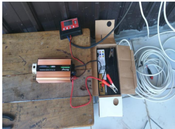
Gambar 7 Koneksi Antara Solar Controller-Baterai-Aki
