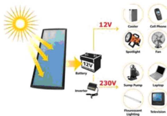
Gambar 3 Prinsip Kerja Listrik Tenaga Surya ( http://solarsuryaindonesia.com/tenaga-surya )
