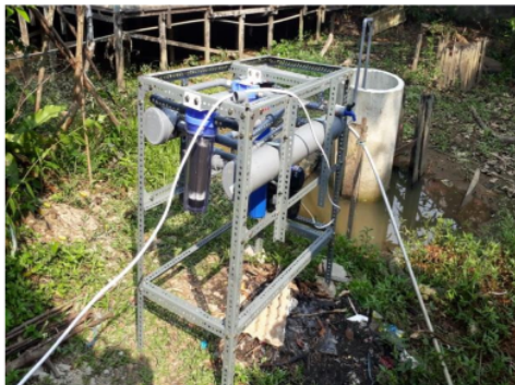
Gambar 3. Filter sederhana serat batang kelapa dan arang yang telah dirakit
