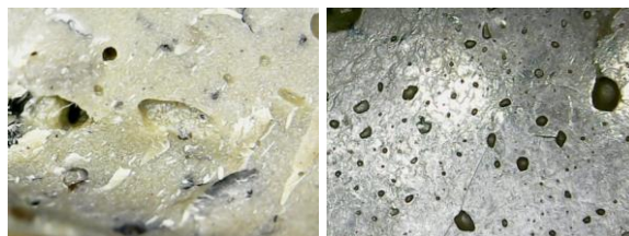
Gambar 9. Foto Makro Patahan dan Permukaan Spesimen B3.3 0% Oli Bekas + 100% HDPE
