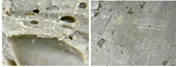
Gambar 5. Foto Makro Patahan dan Permukaan Spesimen A2.3 40% Oli Bekas + 60% HDPE dan PET (50%:50%)
