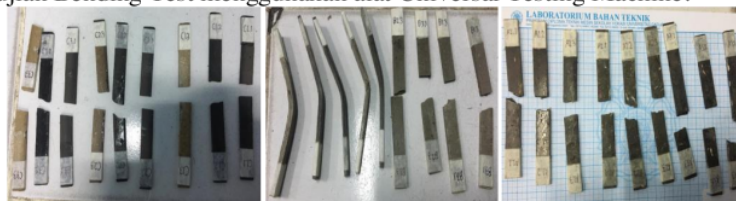
Gambar 3. Hasil Pengujian Kekuatan Tekan (Bending Test)
