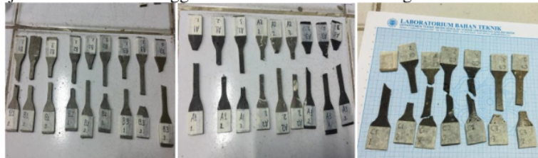
Gambar 2. Hasil Pengujian Kekuatan Tarik (Tensile Test)
