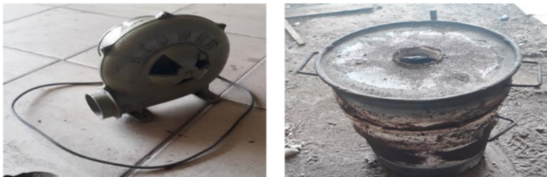
Gambar 8. (a) Alat Pembesar Tekanan (Blower Keong) (b) Wadah logam lebur Tungku Kursibel
