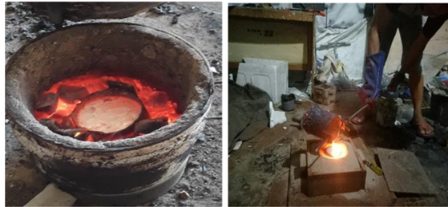
Gambar 11. (a) Peleburan Material. (b) Penuangan material yang sudah mencair
