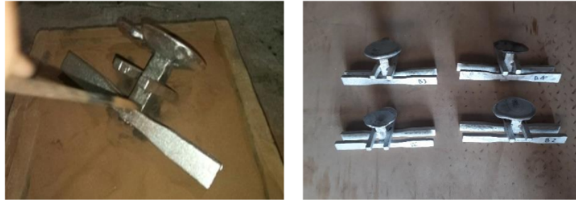
Gambar 11. Hasil Pengecoran Wajan Nagara dan Wajan Jawa
