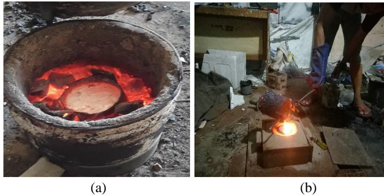
Gambar 11. (a) Peleburan Material. (b) Penuangan material yang sudah mencair
