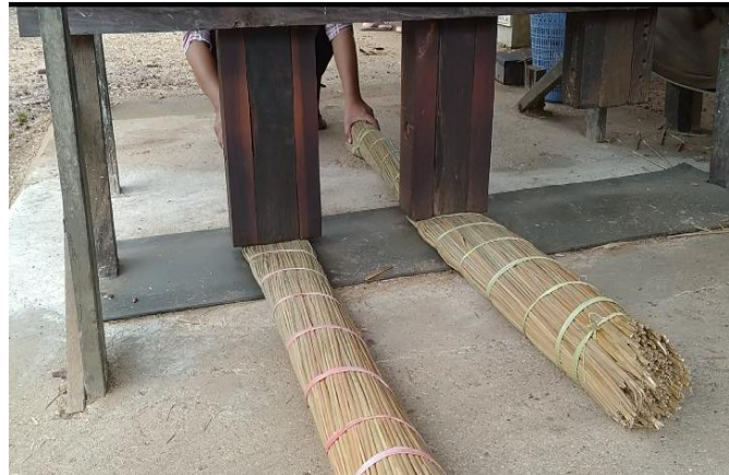
Gambar 6. Bantalan pelindung rantai alat penumbuk purun
