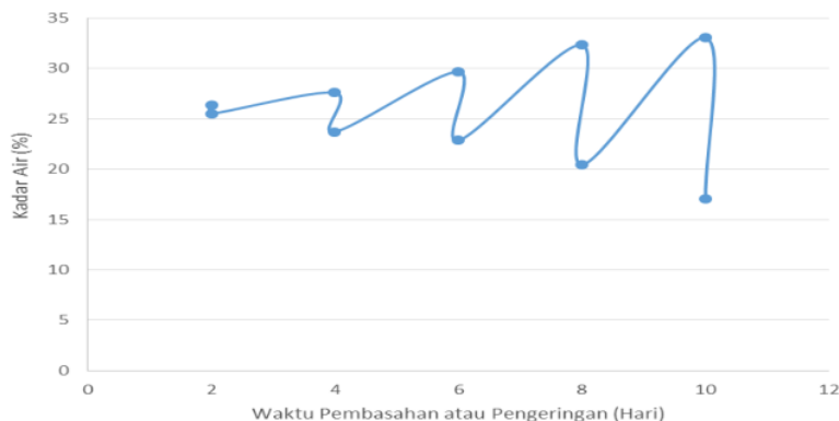
Gambar 5. Hubungan antara keadaan waktu siklus pembersihan atau pengeringan dan Kadar Air untuk kondisi Kekuatan Sisa (Residual)
