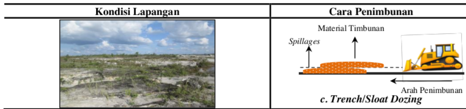
Gambar 7. Cara Penimbunan Lubang Bekas Tambang Lokasi Penelitian
