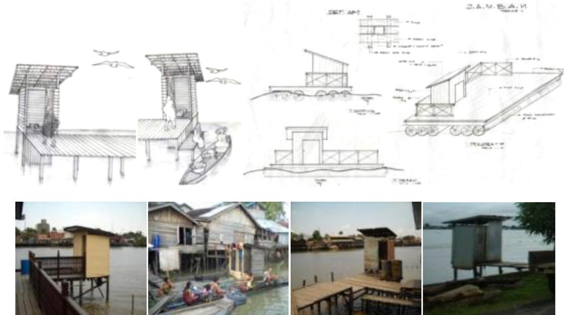
Gambar 8. Jamban umum dengan konstruksi panggung dan konstruksi rakit
