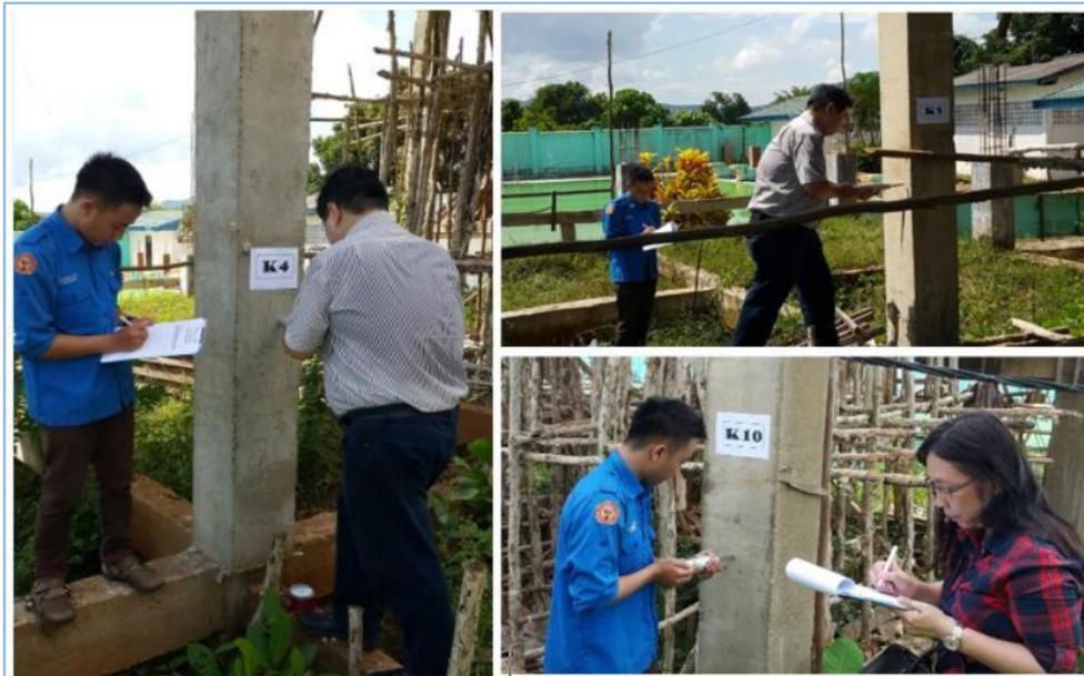
Gambar 3. Pengujian keseragaman mutu beton dengan alat Hammer Test terhadap keseluruhan kolom (10 bh.)
