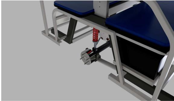
Gambar 8 Rancangan sistem *breaking*
