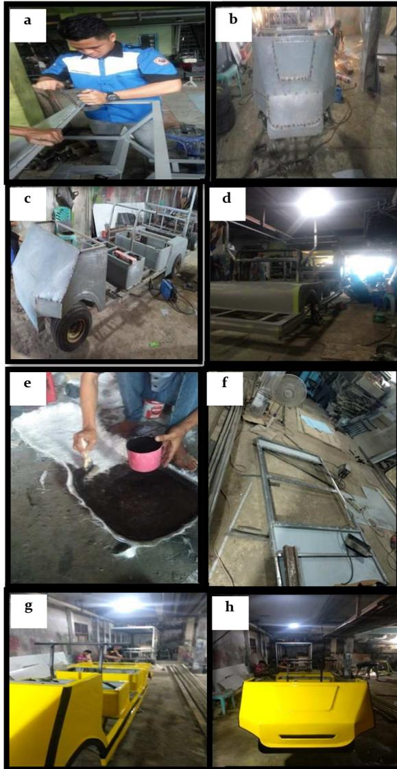
Gambar 15 Proses pembuatan bodi kendaraan
