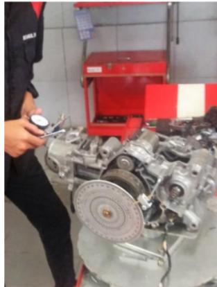
Gambar 14. Pengukuran Durasi *Camshaft*
