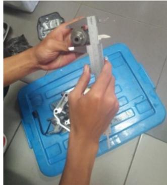
Gambar 13. Pengukuran Dimensi *Camshaft*
