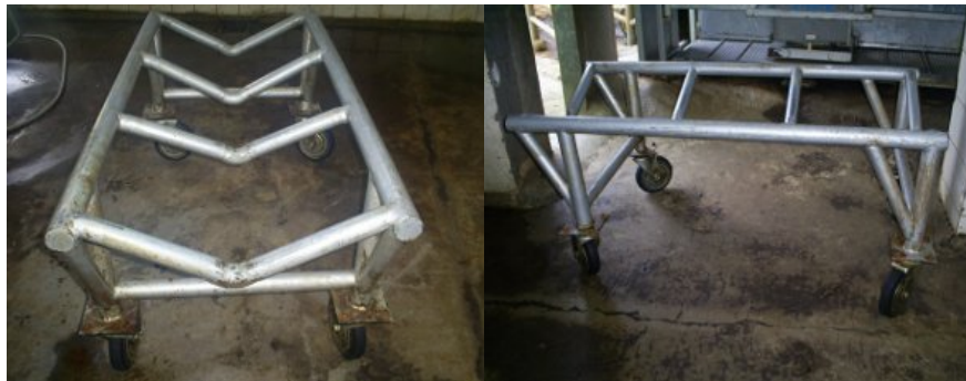
Gambar 10. Cradel, untuk membawa hewan setelah disembelih atau bisa juga untuk Mengangkut karkas (pada pemotongan tanpa sistem gantung)
