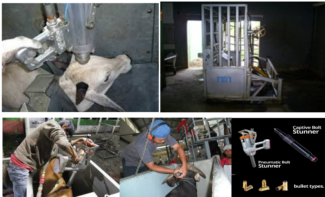
Gambar 16. Proses pemingsanan yang dilakukan di restraining box dengan menggunakan beberapa jenis alat pemingsan ( stunning gun )
