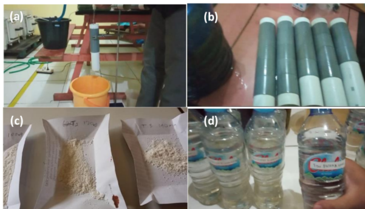
Gambar 2. Proses filtrasi air gambut (a). Proses filtrasi, (b). Variasi Filtrasi, (c). Prosentase Tawas yang digunakan dan (d). Hasil Filtrasi
