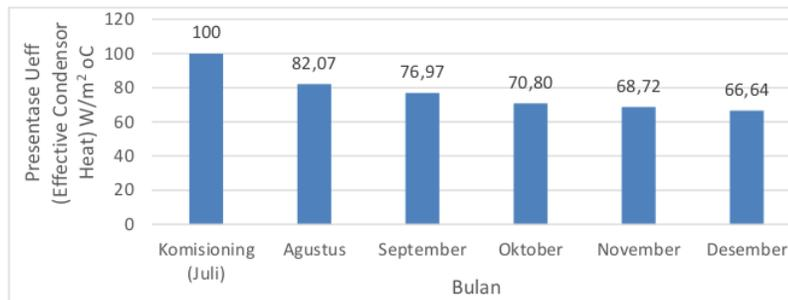
**Gambar 4:** Diagram Batang Hubungan Waktu Terhadap Presentase Nilai Penurunan U<sub>eff</sub>
