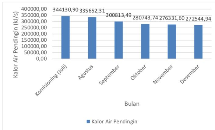
**Gambar 5:** Diagram Hubungan Waktu Terhadap Kalor Air Pendingin
