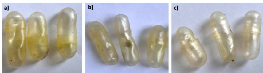
Gambar 2. Penampakan fisik cangkang kapsul keras berdasarkan suhu operasi, a) 50 °C, b) 70 °C, dan c) 100 °C.
