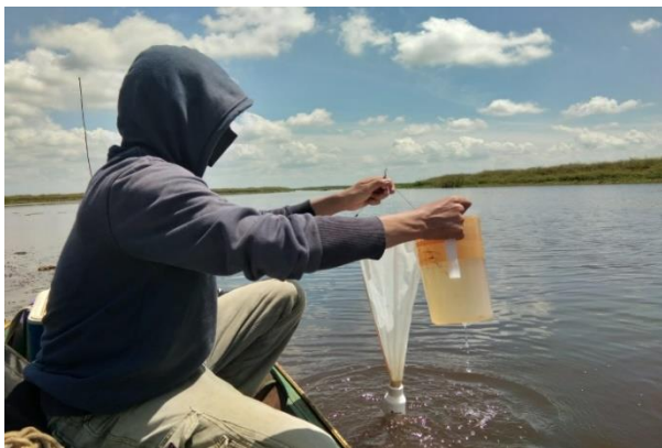
Foto 3. Pengambilan sampel plankton dengan plankton net
