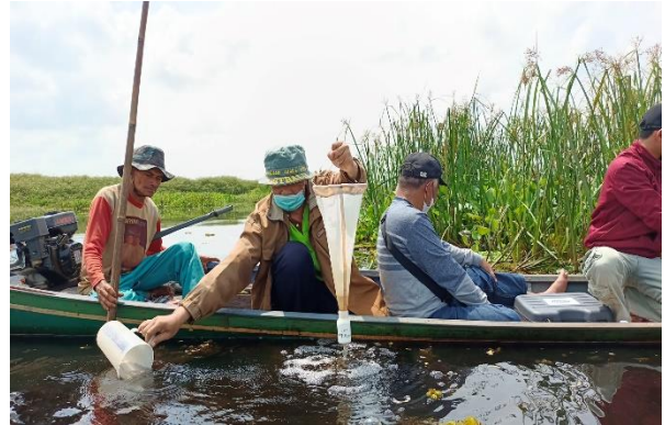
Foto 24. Pengambilan sampel plankton dengan plankton net
