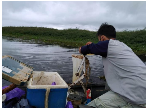
Foto 18. Pengambilan sampel plankton dengan plankton net
