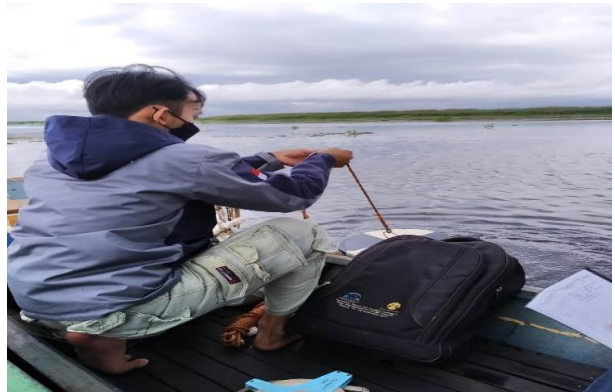
Foto 20. Pengukuran kecerahan air dengan secchi disk
