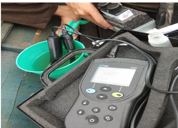
Foto 11. Pengukuran pH air dengan pH meter secara in situ (Agustus 2021)
